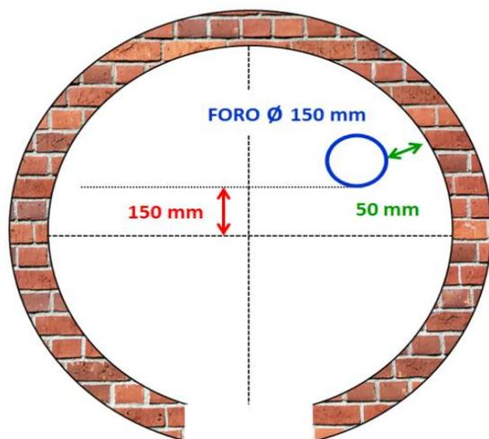
Positionsdiagramm der Bohrung zum Einsetzen des Brenners Drago in der Garebene des Holzofens, Obenansicht. Die Bohrung kann sowohl von der rechten als auch von der linken Seite gemacht werden. Der Brenner muss zur Mitte des Ofenbodens ausgerichtet sein, eventuell mit F1 (erste Flamme) in Richtung Ofenmündung.
